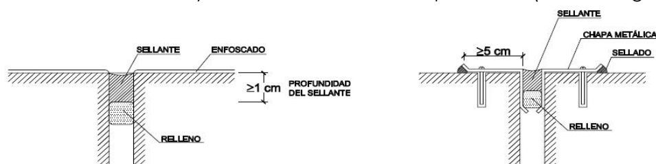
Figura 2.6 Ejemplos de juntas de dilatación
